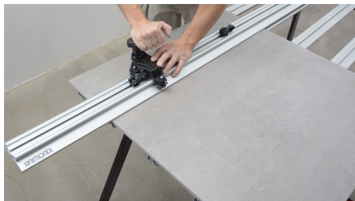
Opridsning af flise med styreskinne
