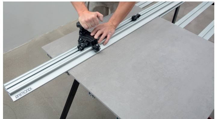
Opridsing av flise med styreskinne
